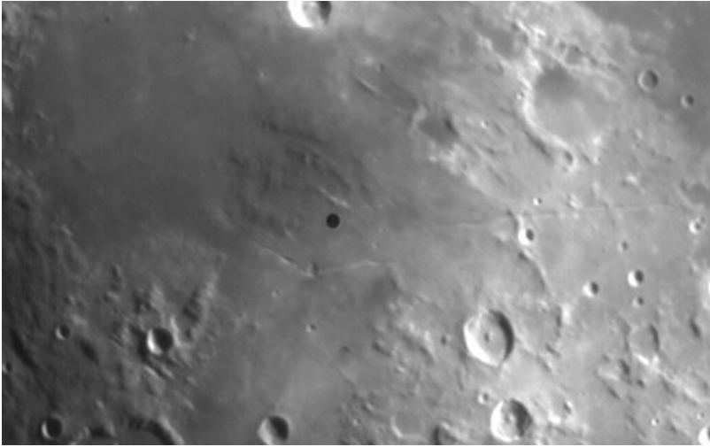
Bonnette : trou d'entrée du spectrographe de 50 microns
