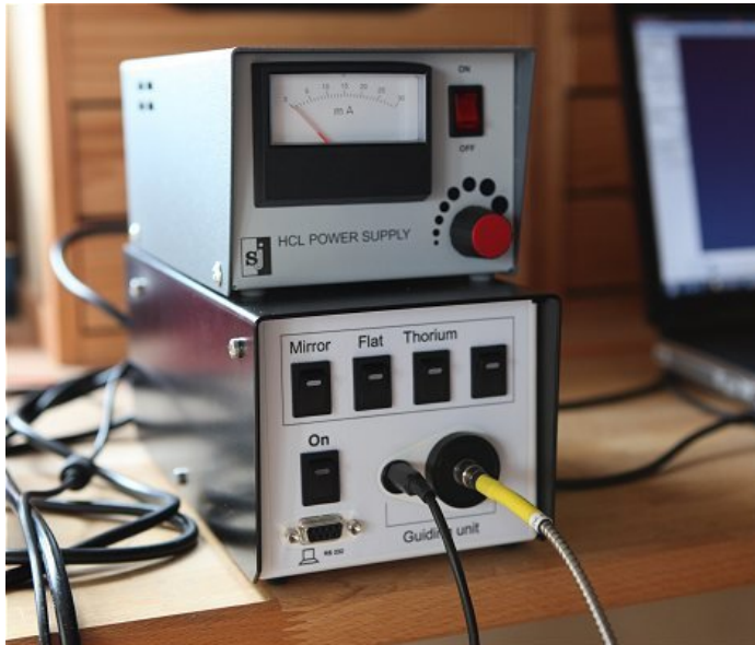
Forte automatisation (étalonnage spectral, lampe ThAr)
