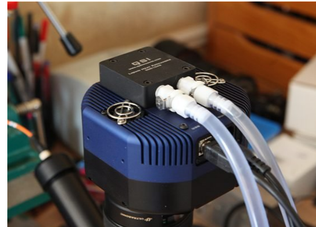
Refroidissement efficace (circuit d'eau sur caméra QSI)
